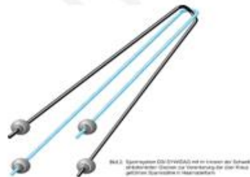
Bild 3.44 Spannstab in Haarnadelform (nachträglicher Verbund)
